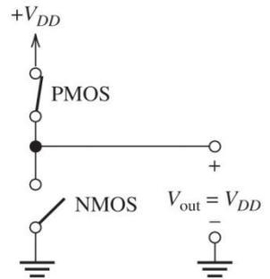
(d) Equivalent circuit with  $V_{in}$  low
